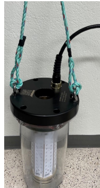
Figur 10. Korrekt oppheng av FCL-600
