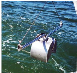
Fig. 3. Small Van Veen grab sampler.
