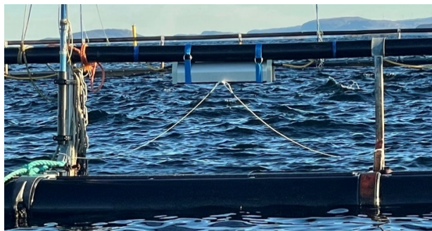
Figur 4. PDC montert på håndrekke med sekundærsikring
