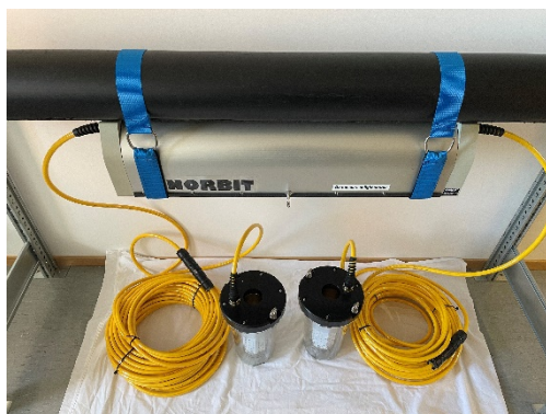
Figur 1. En PDC driver to lys à 600 watt
