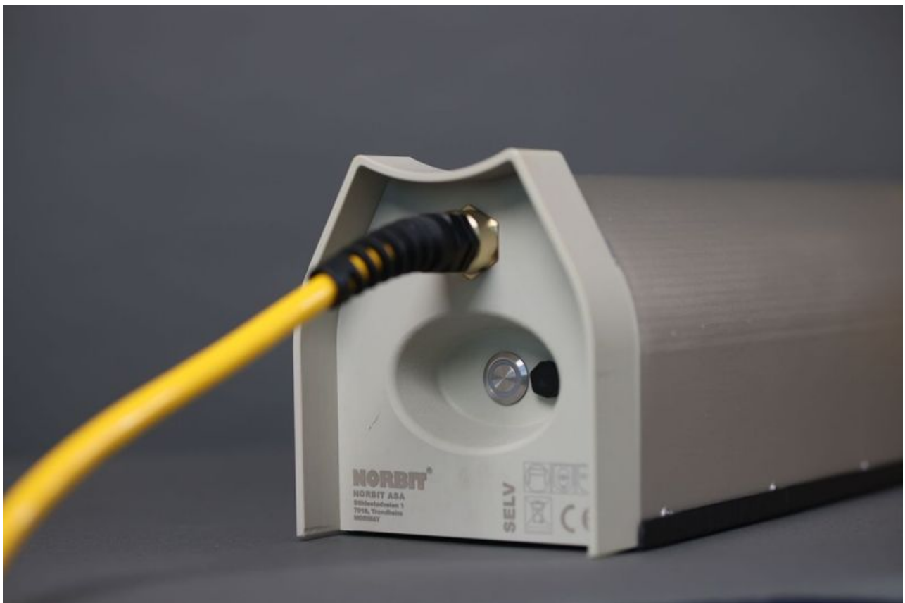
Figur 11. Av/på knapp (sølvfarget). Svart «mutter» er for trykkutjevning og skal ikke røres.
