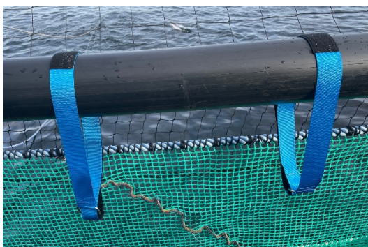
Figur 5. Borrelåsbånd klargjort for montering av PDC.
